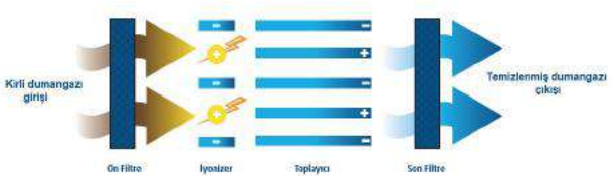
Şekil 17: Elektrostatik Filtrenin Çalışma Prensibi.
