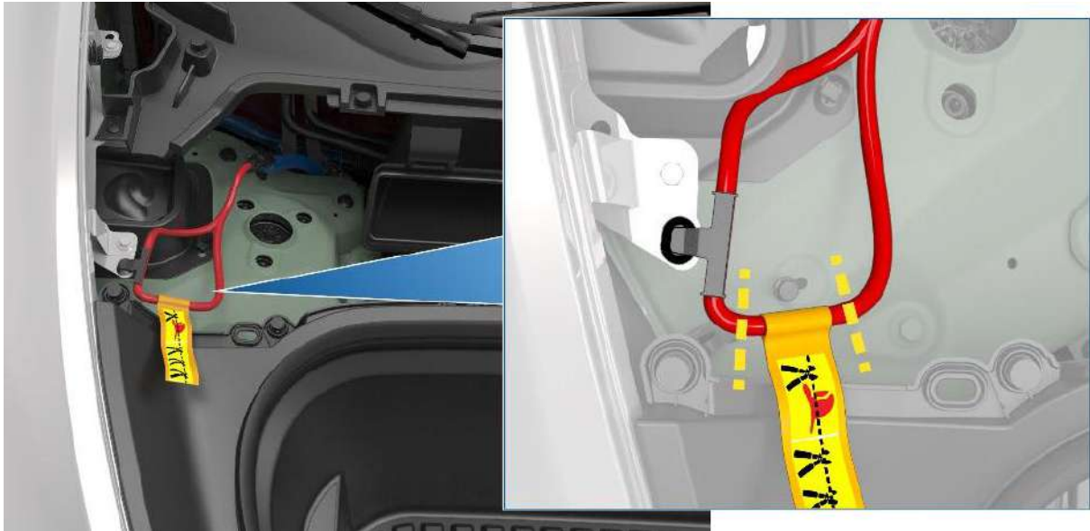
Resim 4: Elektrikli Araç Yangınında 12 V Güç Kablosunun Kesilmesi
