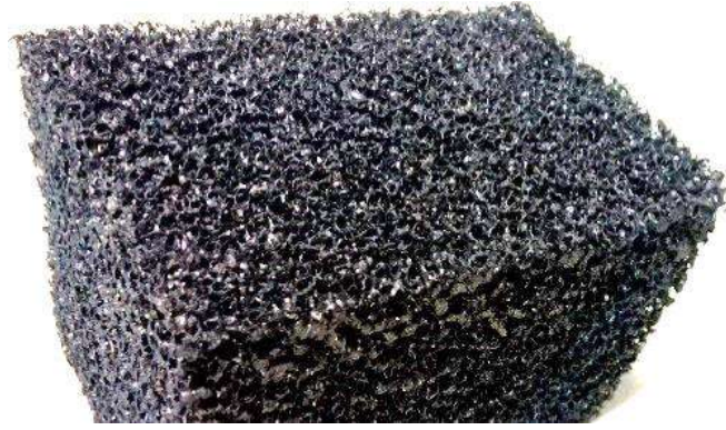
Şekil 4. Patentli intümesan köpük levhanın içyapısı.
