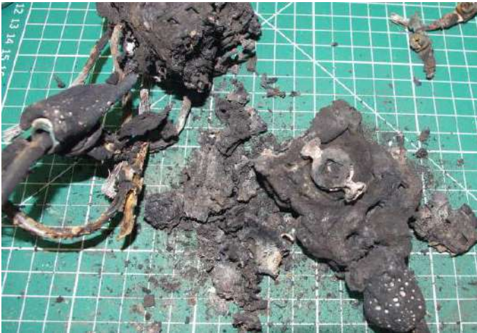
Laboratuvarda sökülüp incelenen bir DC izolatörünün kalıntıları
