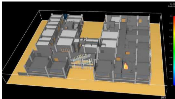
Şekil 5. Yangın simülasyonunun gerçekleştirilmesi ve Alev durumunun incelenmesi
