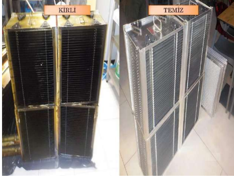
Şekil 19: Temizlik öncesi kirli ve temizlenmiş elektrostatik filtre uygulaması
