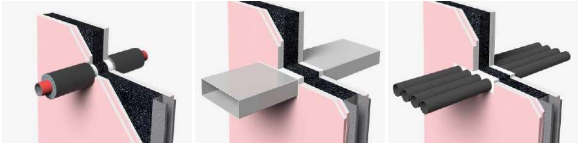
Şekil 7. Mekanik tesisat geçişlerinde intümesan köpük levha
