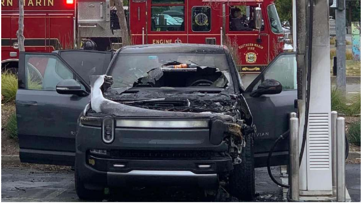
Şekil 4. Şarj Esnasında Elektrikli Araç Yangını
