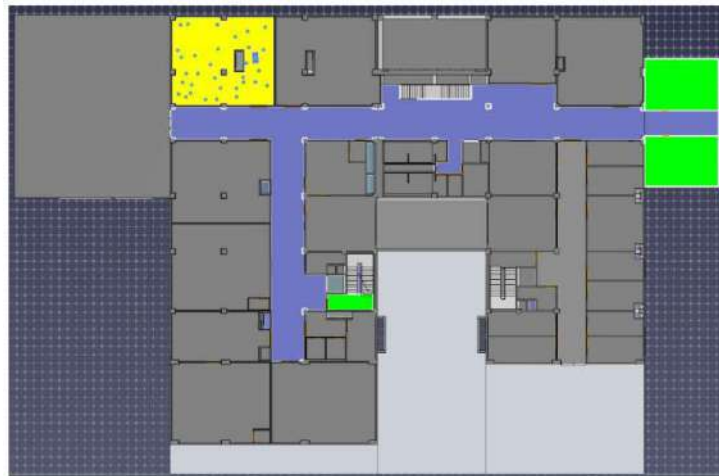
Şekil 10. Simülasyon modelinin iki boyutlu görünümü (sarı: laboratuvar, mavi: koridor, yeşil: acil çıkış/yanğın merdiveni/kaçış odası)
