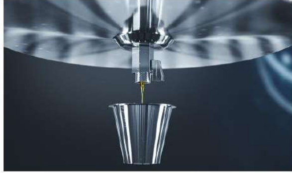
Biriken yağ, bir vana aracılığıyla toplama tavaşından boşaltılır.
